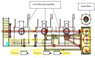
Fig. 3. Cores production line
