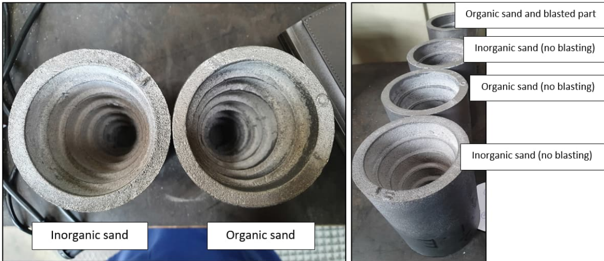
CTIF's shaken-out castings
