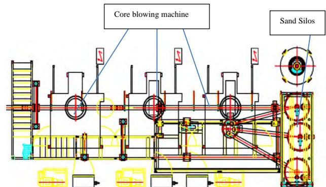
Fig. 3. Cores production line
